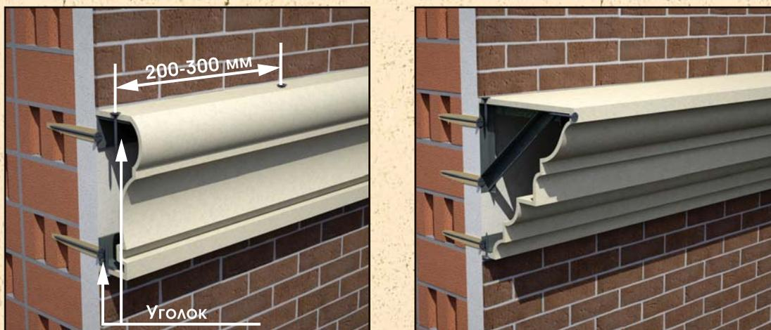
При использовании изделий с выносом от стены более 150 мм или при монтаже на стены с утеплителем, монтаж необходимо проводить на предварительно установленный на стену кронштейн из алюминиевых или оцинкованных профилей.
