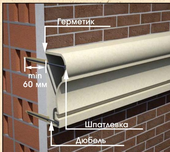
1. Просверлите в изделии отверстие под саморез и сверлом большего диаметра сделайте зенковку для крепления самореза «впотай». Обычно достаточно 4 отверстий на метровый наличник высотой и глубиной профиля не более 150x150 мм.
